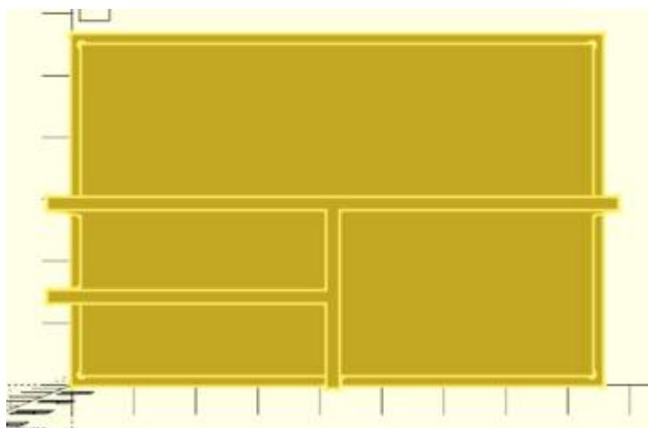
Die vierte und letzte Wand. Diese geht von der oberen Kante zu der dritten Wand. Dadurch ist nun auch der Kabelschacht sichtbar.
