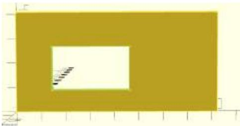
Das rechte Fenster ist 13,75 mm breit und 15,50 mm hoch. Die linke untere Ecke befindet sich bei 19,75 mm (23,75 - 4) und 11 mm. Daher stellt sich der Aufruf für das Fenstermodul wie folgt zusammen:
