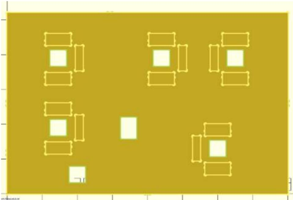
Die Halterung für die LED für die Küche wurde um 90° gedreht, damit die Halterung, sowie später auch die LED in das Haus passen.
