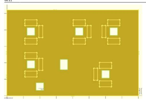
Die Halterung für die LED für die Küche wurde um 90° gedreht, damit die Halterung, sowie später auch die LED in das Haus passen.
