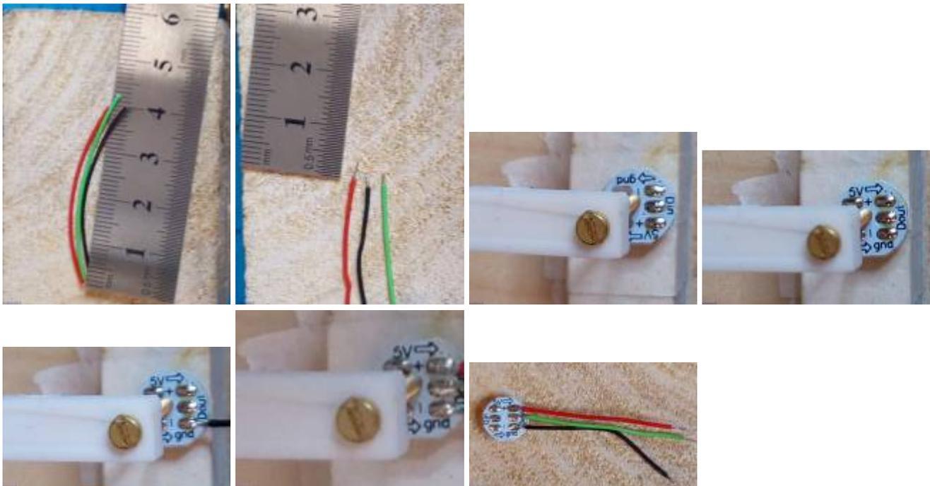
Die Litzen haben dabei eine Länge von 45mm oder 65mm. Die einzige Ausnahme bilden dabei die vier Litzen welche vom Verteiler zu der ersten bzw letzten LED führen. Hier verwende ich immer ein Länge von 250mm. Die genaue Länge dieser Leitungen muss aber jeder selber wissen, da jede Anlage andere Verteilerpositionen hat.
