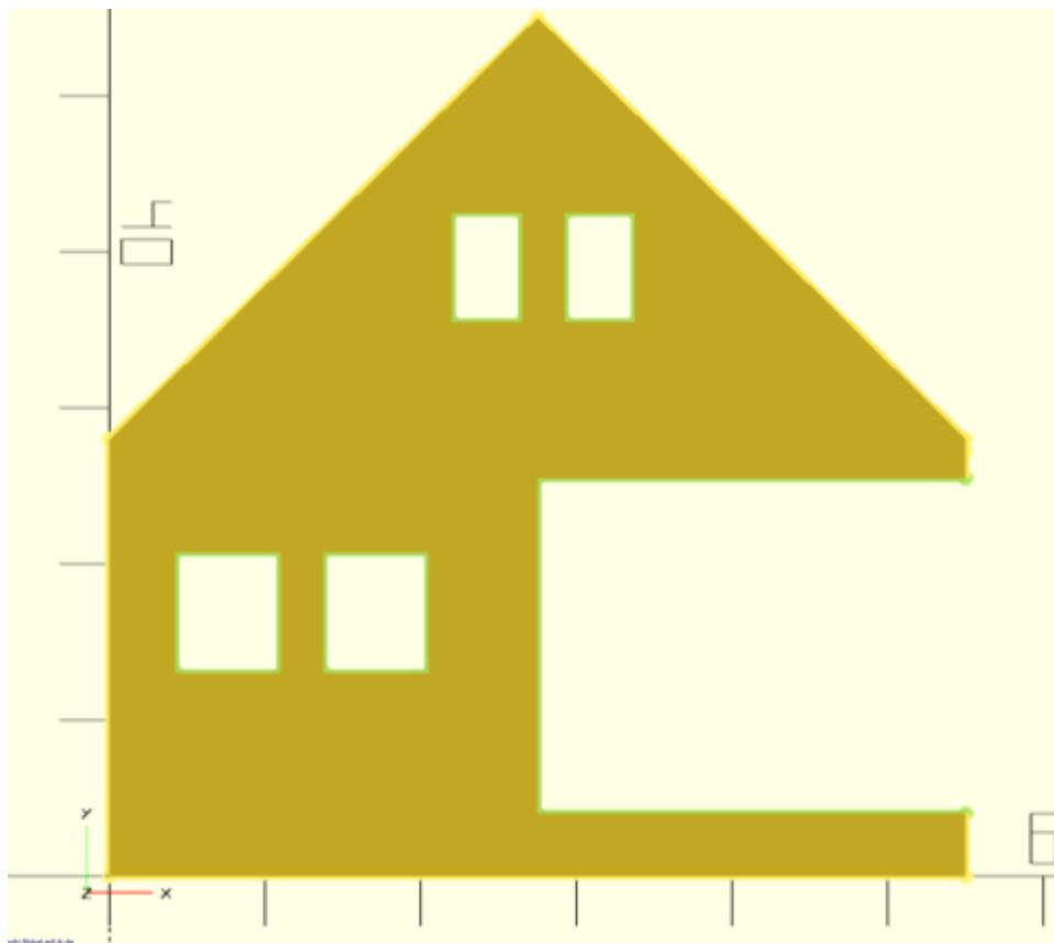
Der einzige Unterschied zu den bisherigen Wänden des Wohnhauses besteht in der zusätzlichen Kante, welche auf der Rückseite der Wand erstellt wird. Diese ermöglicht es dass eine kleinere Zwischendecke verwendet wird, welche ohne Probleme an dem Schaufenster vorbei eingebaut werden kann.
