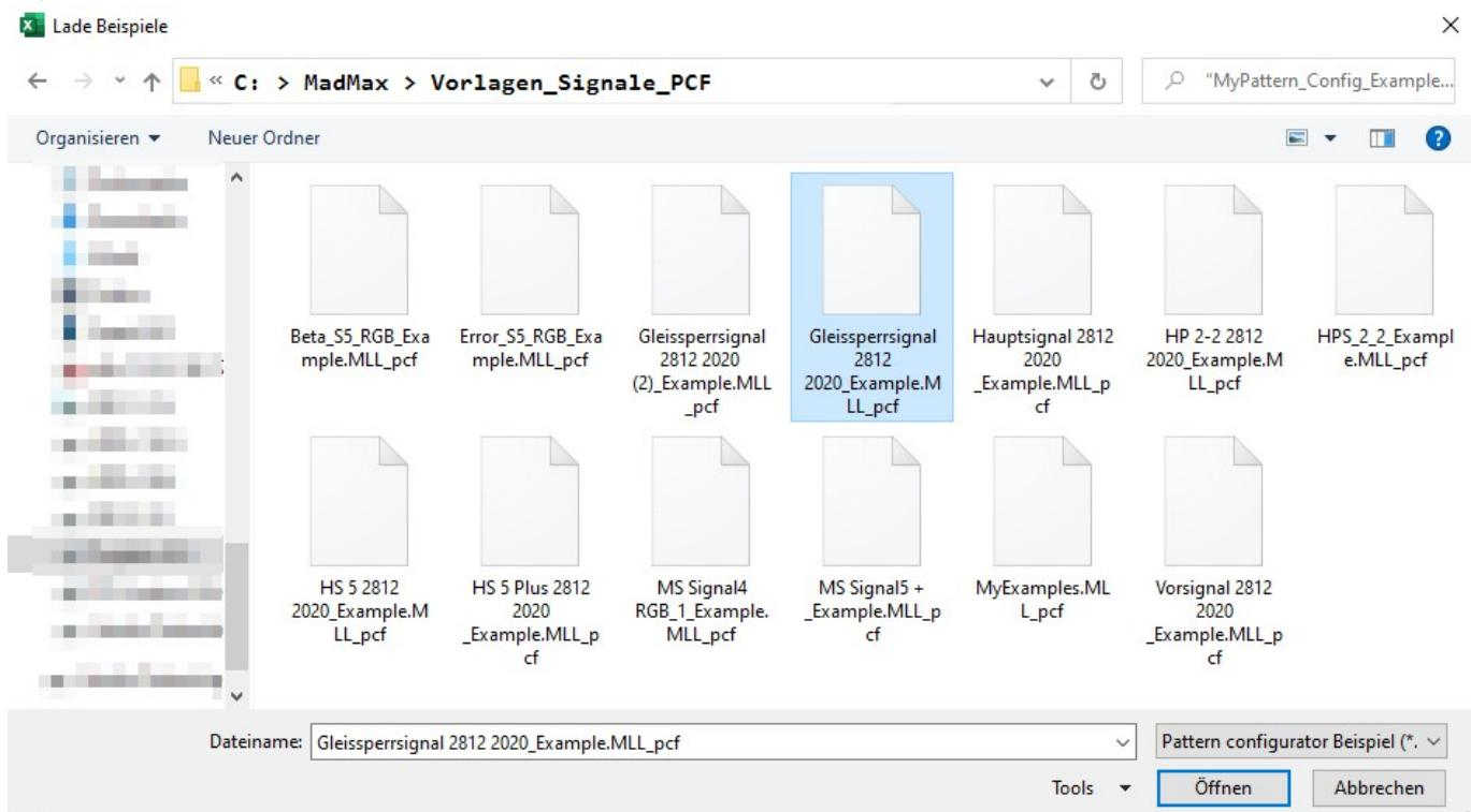
Die Vorlage für das Signal wird dann importiert und eine neue Seite im Pattern-Configurator angelegt und automatisch ausgewählt.
