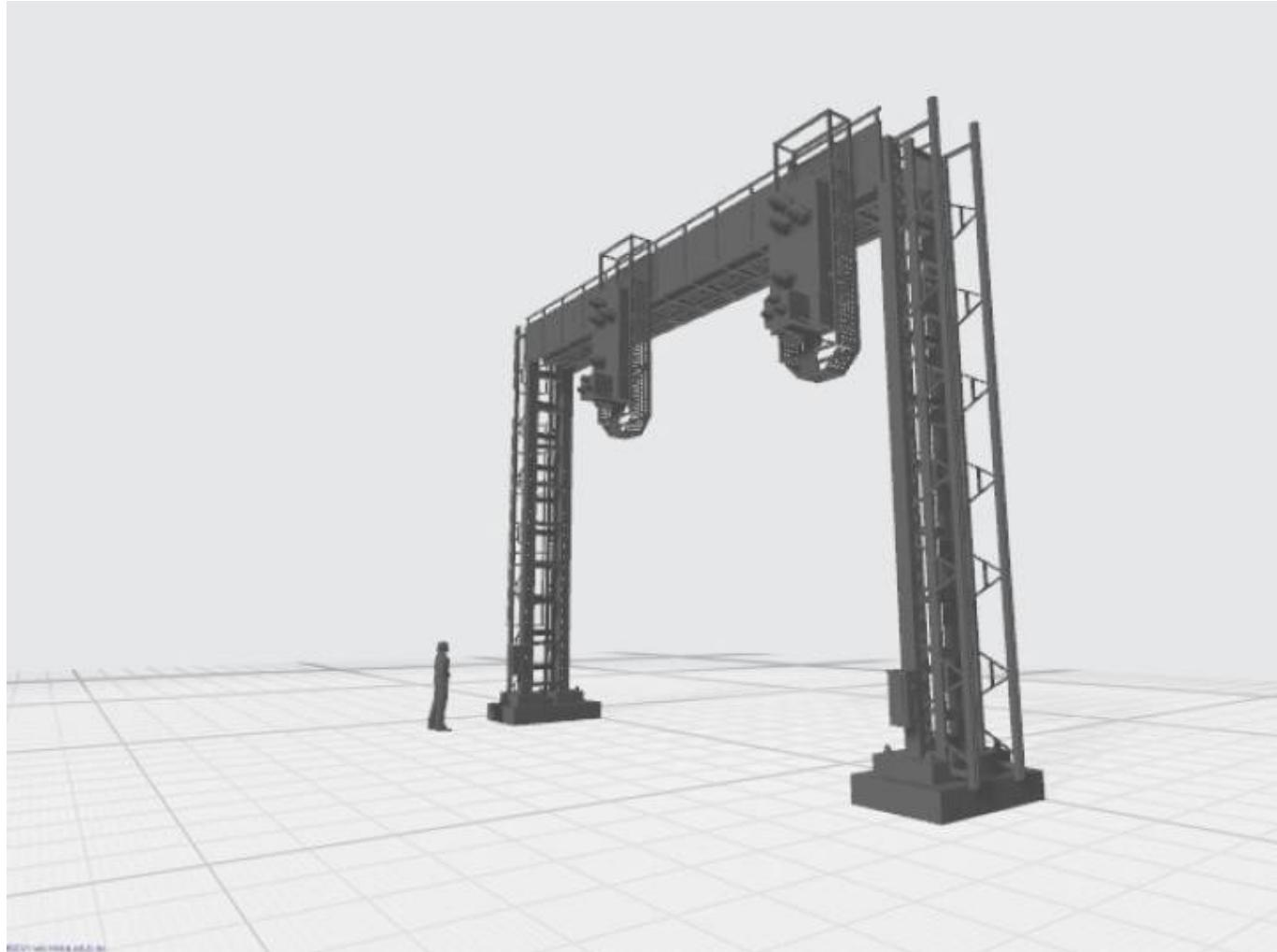
Die Länge der Brücke kann beliebig lang sein, da diese über ein Stecksystem verfügt.
