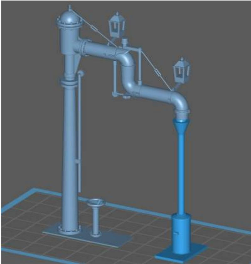
Für den Einbau in die Anlagen- oder Diorama-Platte wird ein 13mm-Loch mit einer Tiefe von mindestens 31mm benötigt. Der Mast ist hohl, sodass hierdurch die Litze für die beiden Laternen geführt werden kann. Soll der Mast mehr als 180 Grad gedreht werden, muss die Litze über einen Schleifring eingeführt werden.
