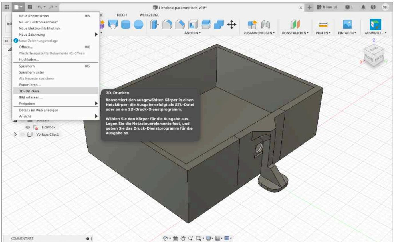
**Schritt 6:** Ist der Druckdialog geöffnet, wird der **Körper** gewählt und das Ganze mit **OK** bestätigt. Der Körper beinhaltet die drei gewählten Objekte Rueckwand, Lichtbox und WS2812 oder Rueckwand,
