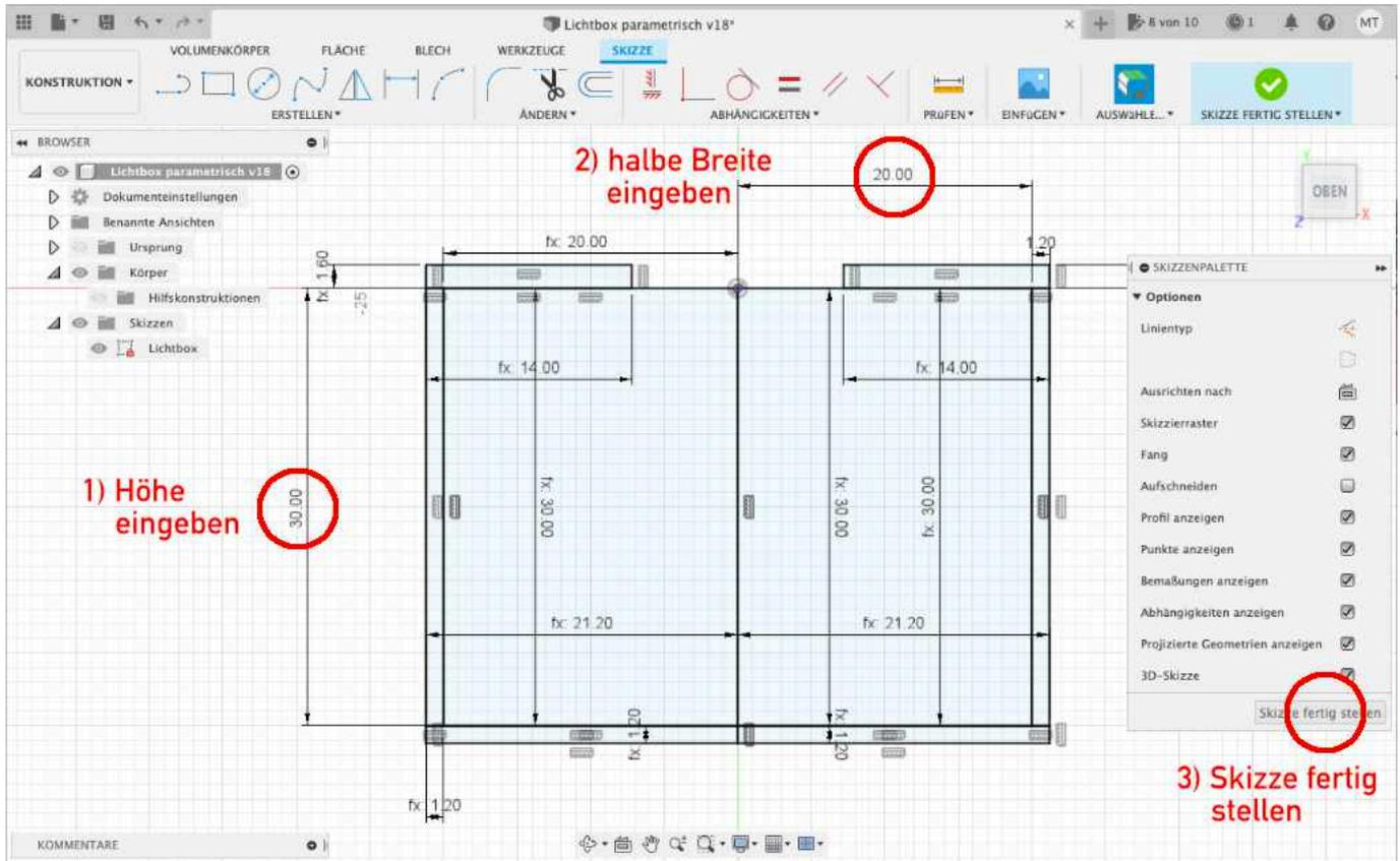
**Schritt 4:** Ist die Größe der Lichtbox festgelegt und die **Skizze fertig gestellt**, kann man über das **Auge** die Sichtbarkeit der entsprechenden LED-Clips wählen.
