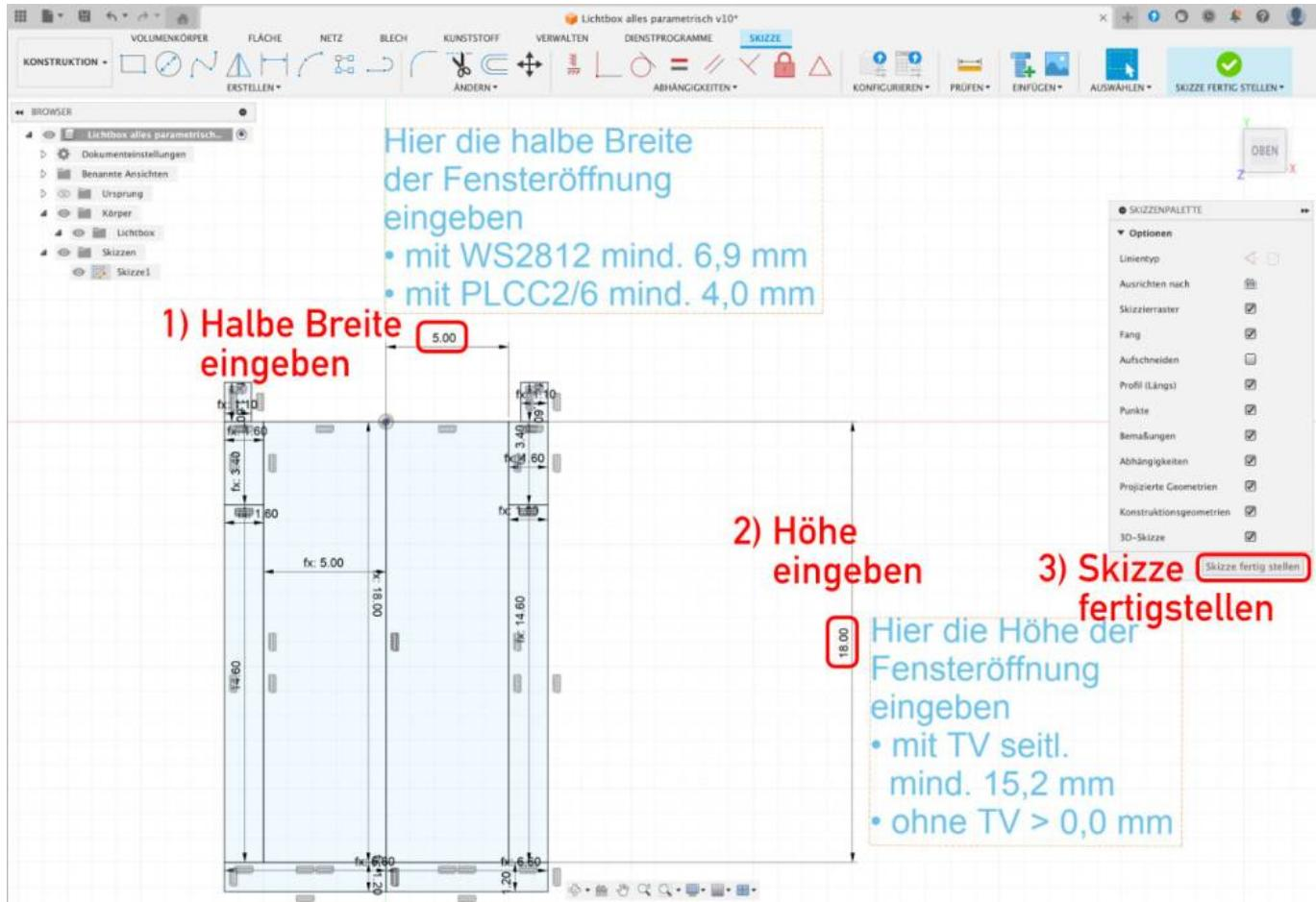
**Schritt 4:** Ist die Größe der Lichtbox festgelegt und die **Skizze fertig gestellt**, kann man über das **Auge** die Sichtbarkeit der entsprechenden LED-Clips wählen. Es darf selbstverständlich nur einer der drei Clips sichtbar sein (**WS2812**, **PLCC 2** oder **PLCC 6**).
