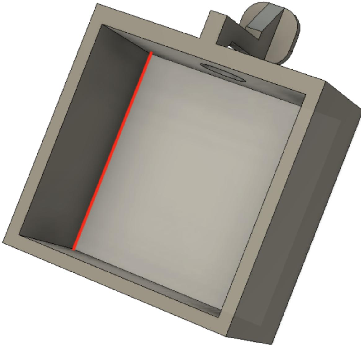
**Schritt 9:** Ist die Fase innen erstellt, wählt man die dazugehörige Kante auf der Außenseite gibt dort den gleichen Wert plus die Hälfte der Wurzel aus 2 ein. Das geht in Fusion glücklicherweise per Formel.
