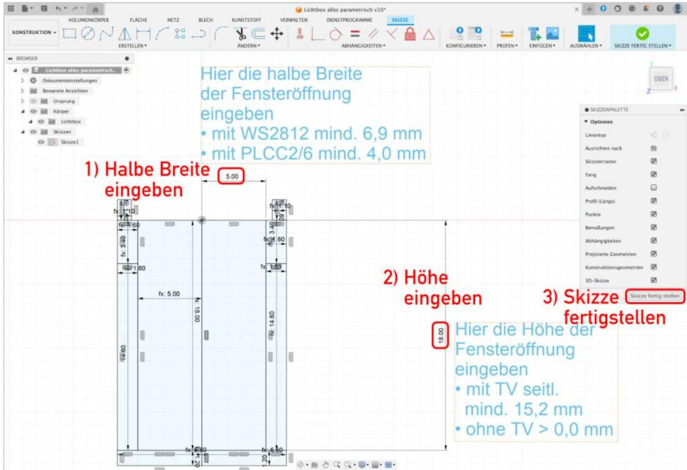
**Schritt 4:** Ist die Größe der Lichtbox festgelegt und die **Skizze fertig gestellt**, kann man über das **Auge** die Sichtbarkeit der entsprechenden LED-Clips wählen.
