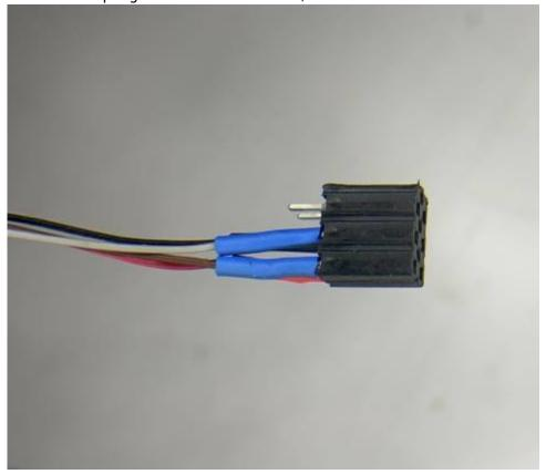
Das Innenleben wird von oben eingesetzt und die Printbuchse an den Stiften des Pfostensteckers angesteckt.
