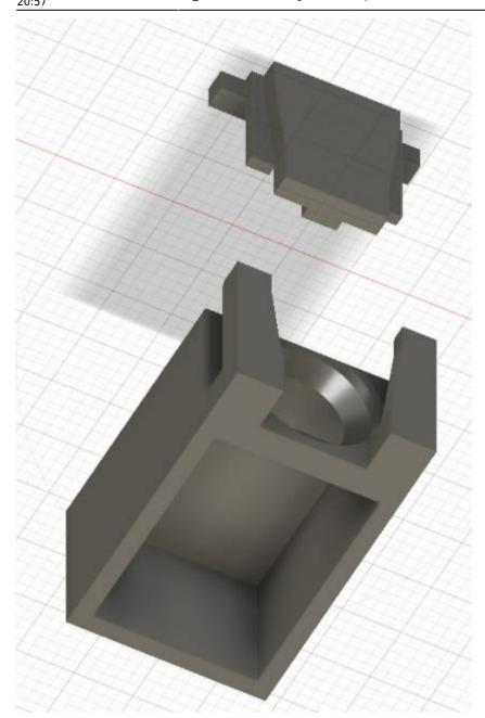
Für alle Lichtboxen kann der selbe Deckel verwendet werden. Der Deckel kann optional mit einem Tropfen Heißkleber von hinten fixiert werden. Heißkleber klebt gut auf Resin und lässt sich trotzdem leicht wieder entfernen.
