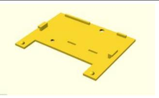
Für die neueren Versionen der Hauptplatine ist bei der Verwendung des Selectrixinterfaces ein angepasstes Gehäuse notwendig.
