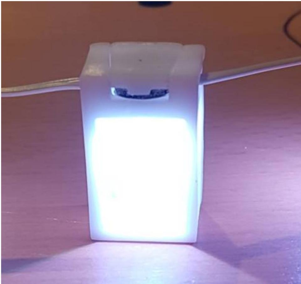
Die Lichtplatten werden anschließend per Hauptplatine programmiert, beispielsweise als „Belebtes Haus“. Das fertige Haus vermittelt den Eindruck, dass hinter den Fenstern echte Zimmer zu sehen sind. Es wirkt besonders realistisch, wenn die LED nur schwach leuchten.
