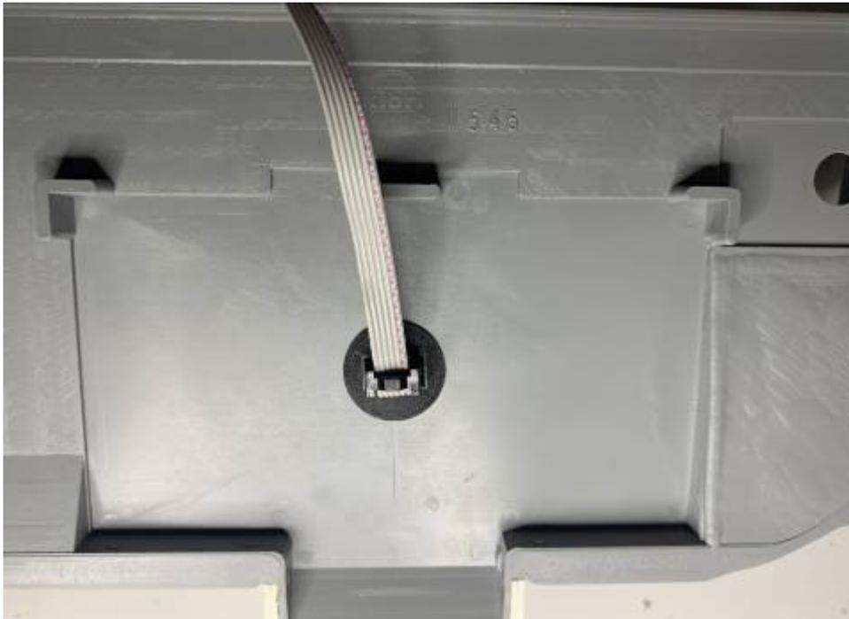
Alternativ kann an die Montagebuchse auch ein Kabel angelötet werden, hierfür ist eine Zugentlastung vorgesehen.
