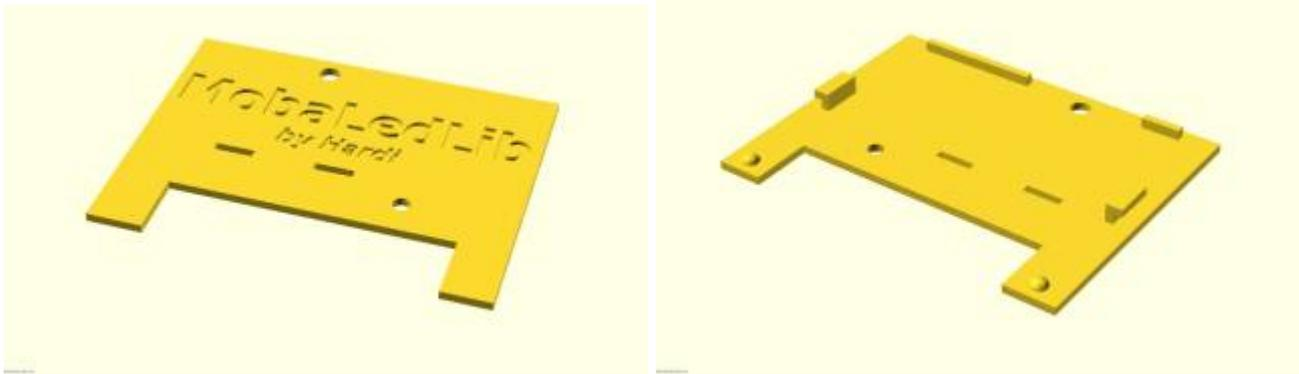
Für die neueren Versionen der Hauptplatine ist bei der Verwendung des Selectrixinterfaces ein angepasstes Gehäuse notwendig.
