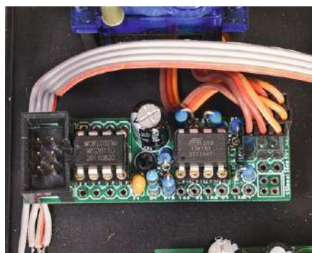
Die Servo-Platine benutzt einen WS2811D-Chip für den LED-Bus und ein ATtiny85-Prozessor für die Servoansteuerung. Es können drei Servos angesteuert werden.
