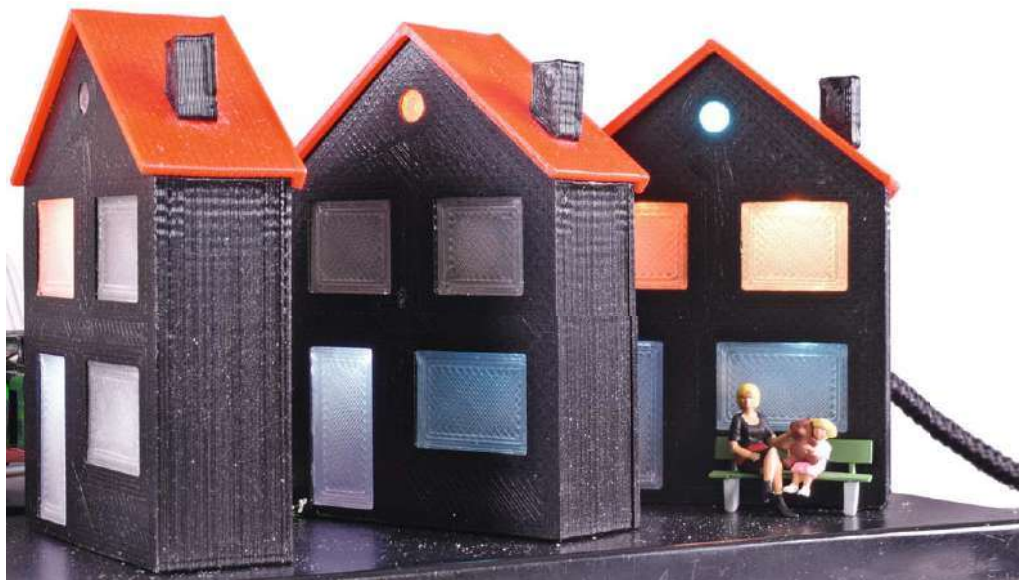
In den Häusern stecken jeweils mehrere RGB-LEDs und auch Einzel-LEDs, die nur von einem vierpoligen Kabel versorgt werden müssen. Alle Fotos: Heiko Herholz
