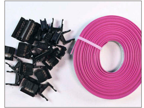
Beim Ausbau mit weiteren MobaLedLib-Platinen kommen Flachbandkabel und Pfostenklemmstecker zum Einsatz.
