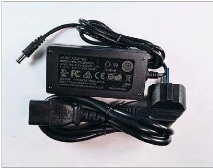
Das mitgelieferte 5-Volt-Netzteil kann bis zu drei Ampere Strom liefern und ist damit auch für viele RGB-LEDs tauglich.
