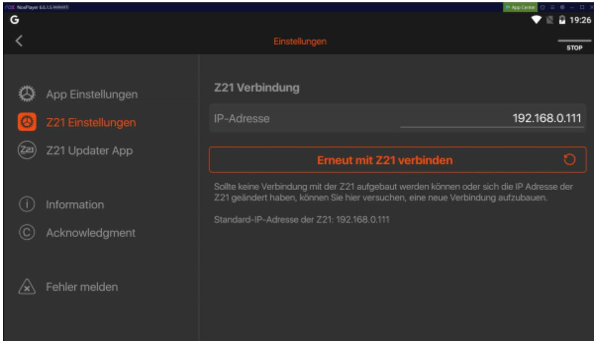
Unter IP-Adresse ist die Standard Z21 IP-Adresse eingetragen 192.168.0.111. Diese Adresse muss ersetzt werden durch die IP-Adresse, die beim Start des Z21 Simulators angezeigt wird. In diesem Fall 192.168.178.73
