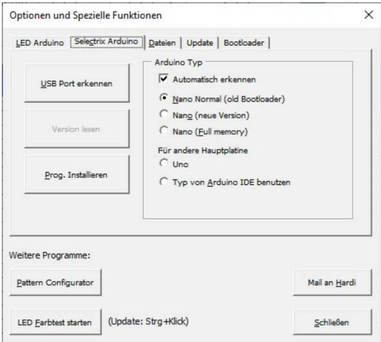
7. „USB Port erkennen“ ausführen /das Programm sucht dabei nach einem angeschlossenen ARDUINO, bestimmt den Typ des ARDUINO und trägt die korrekten Daten in die Felder ein)
