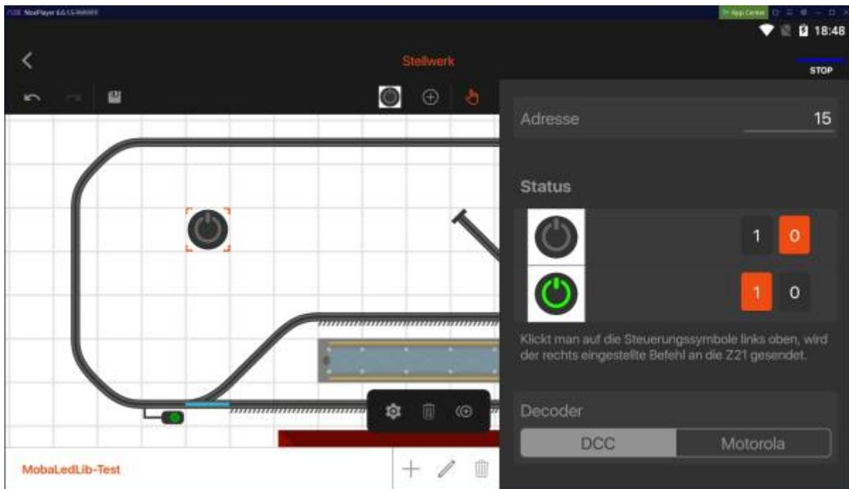
Die Adresse auf 100 ändern. Darauf achten, dass der Decoder auf DCC steht. Durch antippen der Schalter-symbole kann man den Schalter testen.
