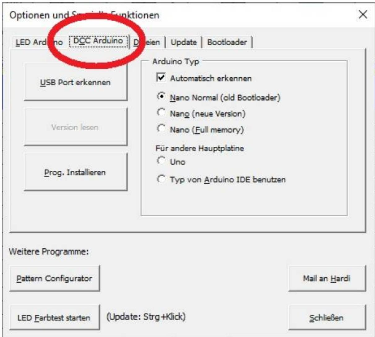
6. „USB Port erkennen“ ausführen das Programm sucht dabei nach einem angeschlossenen ARDUINO, bestimmt den Typ des ARDUINO und trägt die korrekten Daten in die Felder ein)
