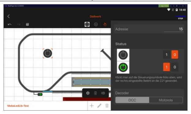
Die Adresse auf 100 ändern. Darauf achten, dass der Decoder auf DCC steht. Durch antippen der Schalter-symbole kann man den Schalter testen.
