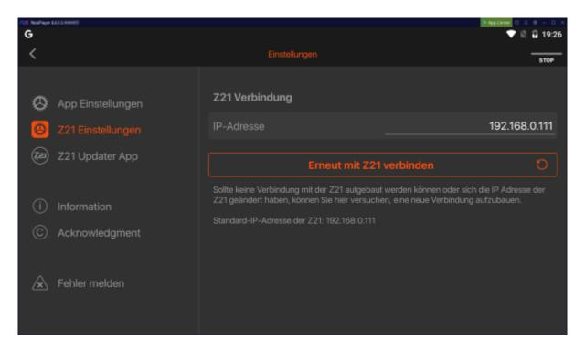
Unter IP-Adresse ist die Standard Z21 IP-Adresse eingetragen 192.168.0.111. Diese Adresse muss ersetzt werden durch die IP-Adresse, die beim Start des Z21 Simulators angezeigt wird. In diesem Fall 192.168.178.73
