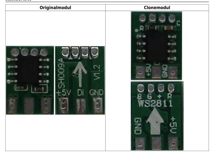
Der Dateneingang ist bei beiden Varinaten auf der Unterseite und mit einem Pfeil markiert. Der Datenausgang ist auf der Rückseite das mittlere Lötpad. Bei beiden Modulen gibt es vor allem den Unterscheid, das VCC (+5V) und GND vertauscht sind. Bitte beachten, anderfalls gibt es ein unschönes Rauchwölkchen.
