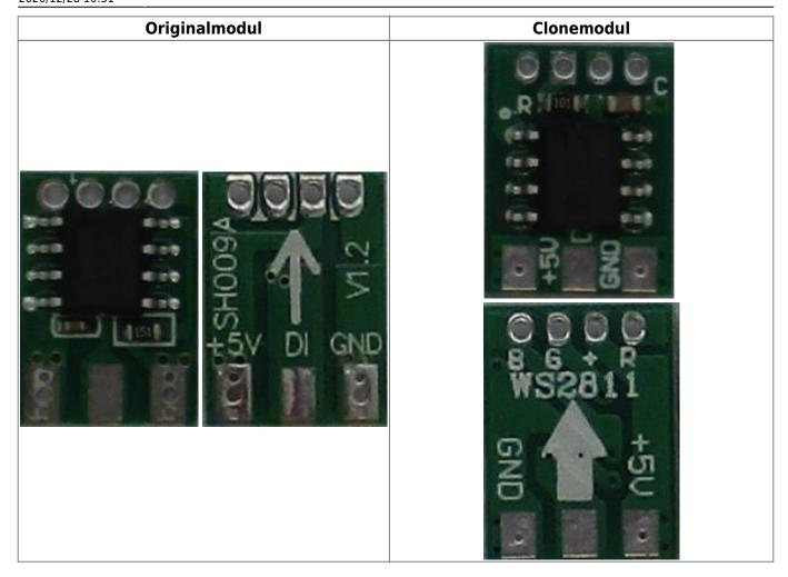
Der Dateneingang ist bei beiden Varinaten auf der Unterseite und mit einem Pfeil markiert. Der Datenausgang ist auf der Oberseite (Seite mit dem IC) das mittlere Lötpad. Bei beiden Modulen gibt es vor allem den Unterscheid, das VCC (+5V) und GND vertauscht sind. Bitte beachten, anderfalls gibt es ein unschönes Rauchwölkchen.
