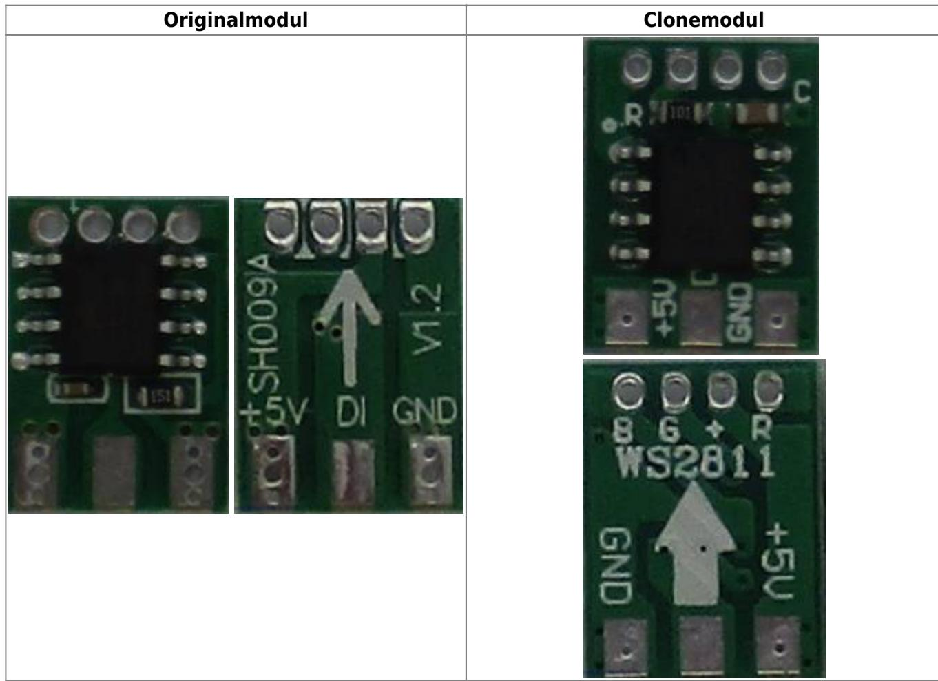
Der Dateneingang ist bei beiden Varianten auf der Unterseite und mit einem Pfeil markiert.
