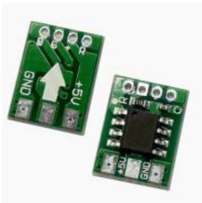
Es können jeweils drei Straßenlaternen (LED) an einem WS2811 angeschlossen. Somit werden bei z.B. 9 Straßenlaternen drei WS2811 Chips benötigt. Die verwendeten LED Lampen benötigen keinen Vorwiderstand. Dies gilt auch für LED Lampen, die für kleinere Versorgungsspannungen ausgelegt sind. Die Begrenzung erfolgt durch den WS2811 selbst. Ausgangsstrom pro Kanal R, G, B jeweils 20 mA max. Somit könnten 60 mA Gesamtstrom fließen Versorgungsspannung 5 Volt
