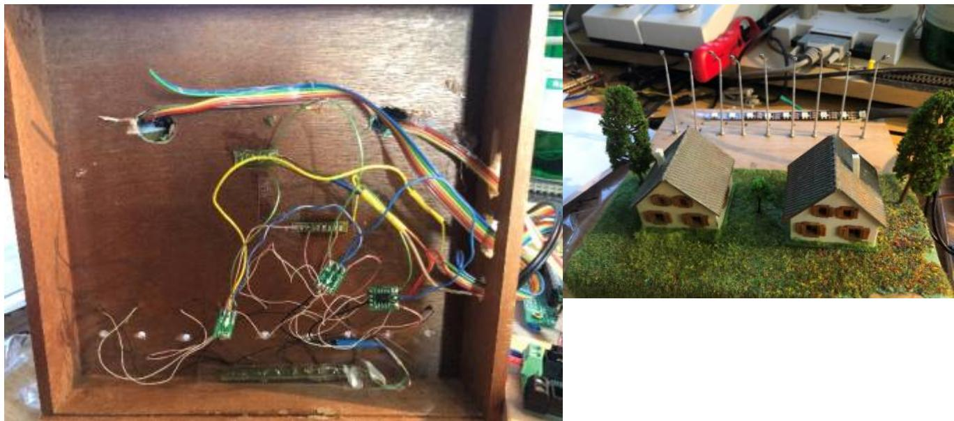
Die Straßenlaternen werden in zufälliger Reihenfolge eingeschaltet, somit ist die Reihenfolge R G B auf dem WS2811 hier belanglos
