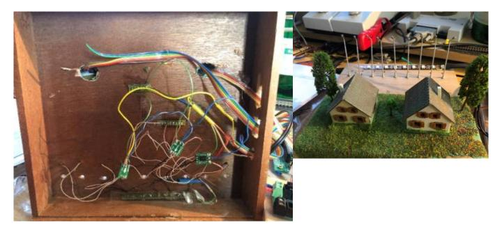
Die Straßenlaternen werden in zufälliger Reihenfolge eingeschaltet, somit ist die Reihenfolge R G B auf dem WS2811 hier belanglos
