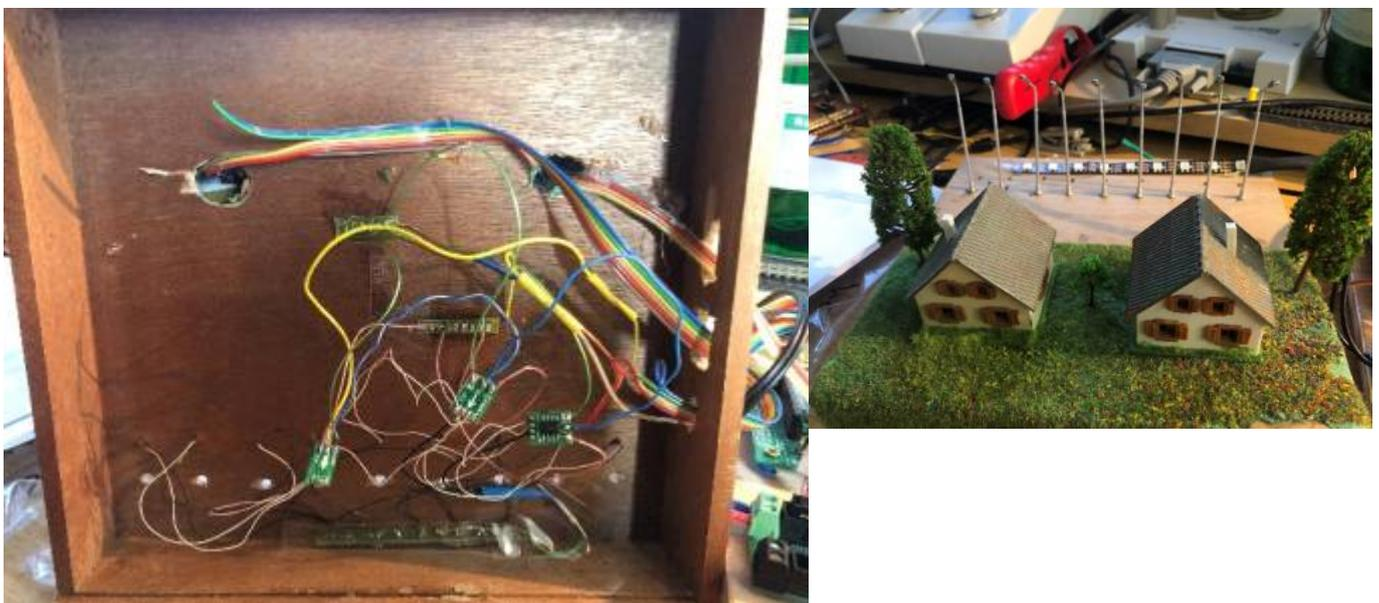
Die Straßenlaternen werden in zufälliger Reihenfolge eingeschaltet, somit ist die Reihenfolge R G B auf dem WS2811 hier belanglos
