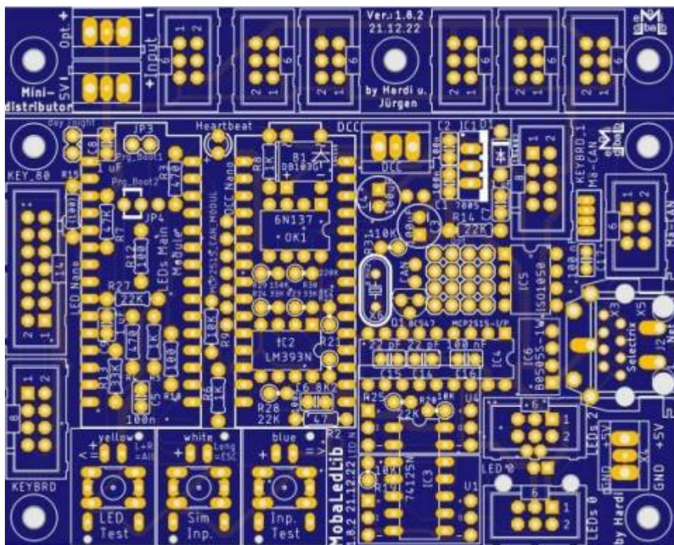
Die Hauptplatine ist eine der beiden Haupt-Zentralen für die MobaLedLib.
