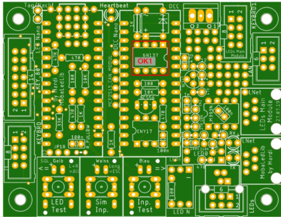
Die nächsten Bauteile sind die vier Buchsenleisten für die beiden Arduinos.
