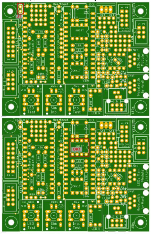
Die nächsten Bauteile sind die vier Buchsenleisten für die beiden Arduinos. Damit diese passen, müssen die Leisten, sollte man die aus dem Reichelt Warnkorb gekauft haben, auf 15 Pole gekürzt werden.
