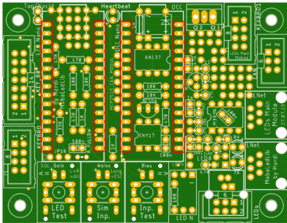
Bei den Buchsenleisten für die Arduinos kann man sich behelfen, indem man die Leisten auf die Arduinostifteleisten steckt und dieses dann in die Hauptplatine steckt.
