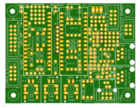
Die nächsten Bauteile sind die zwei Buchsenleisten für den LED-Arduino. Damit diese passen, müssen die Leisten, sollte man die aus dem Reichelt Warnkorb gekauft haben, auf 15 Pole gekürzt werden.
