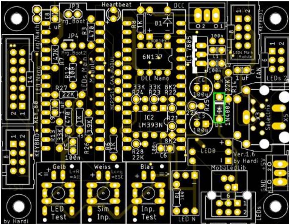
danach folgen die beiden Keramikkondensatoren C1 & C2 (je 100nF)
