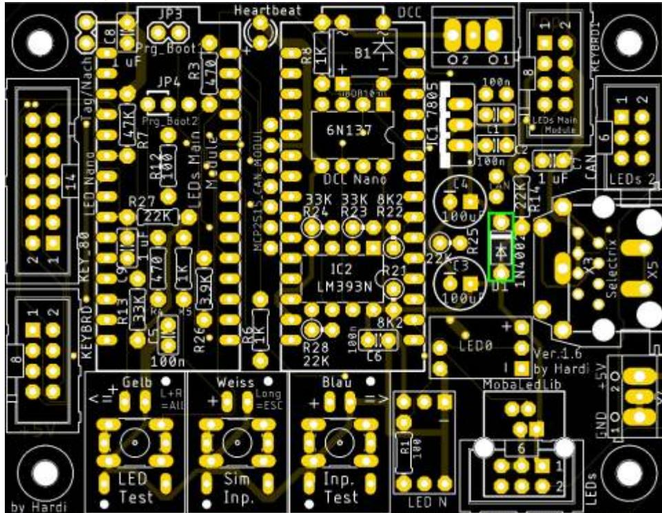
danach folgen die beiden Keramikkondensatoren C1 und C2 (100nF),
