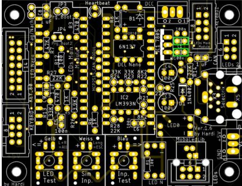
die beiden Elektrolytkondensatoren C3 und C4 (je 100 $\mu$ F/25V)
