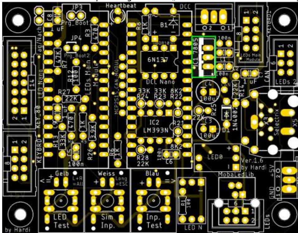
Sollte die Versorgung über den DCC-Bus erfolgen, so wird der Optokoppler (OK1 / 6N137) entfernt und durch die Diode D2 (1N4148) ersetzt.
