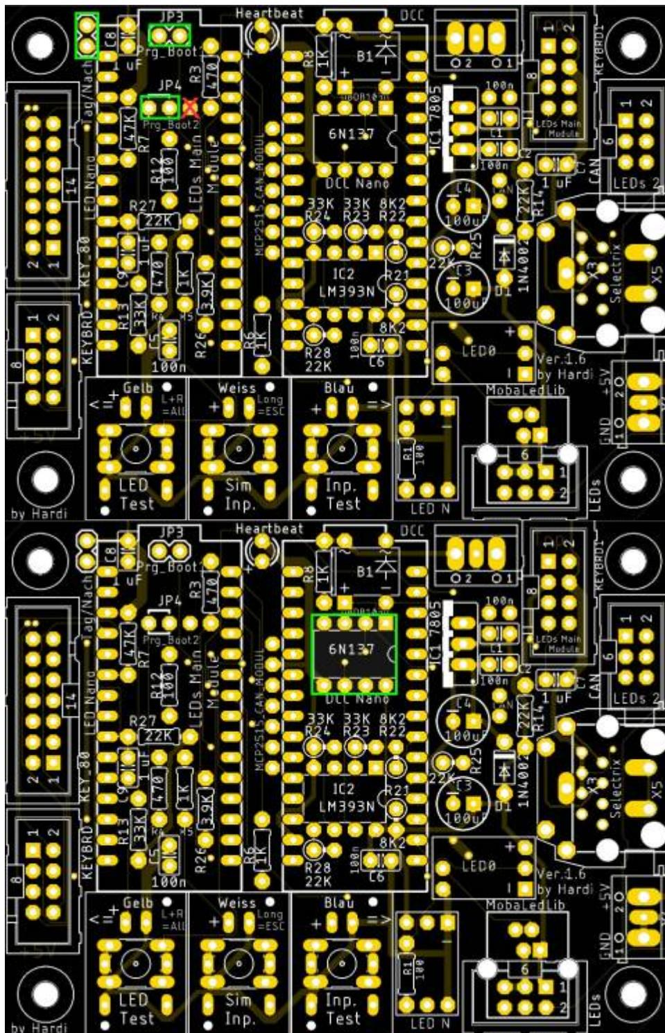
Die nächsten Bauteile sind die vier Buchsenleisten für die beiden Arduinos.
