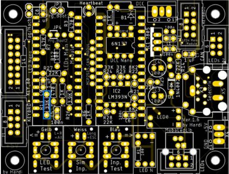
gefolgt von dem Keramikkondensatoren C5 (100 nF).
