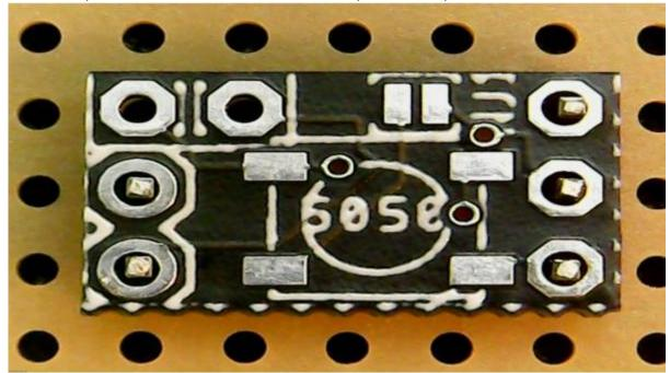
Im Anschluss wird die LED aufgelötet. Dies kann auch per Handlötung erfolgen, wenn es noch nicht zu viel Kaffee zum Frühstück gab. Als erstes auf das Lötpad unten links etwas Lötzinn geben und kurz auskühlen lassen.
