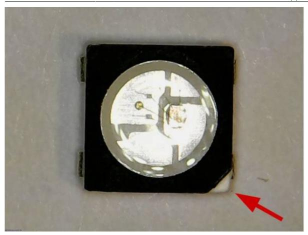
Das Lötzinn mit dem Lötkolben wieder schmelzen und die LED mit der Pinzette auf das Lötpad mit dem geschmolzenen Lötzinn legen und den Lötkolben entfernen. Nach ca. 5 Sekunden ist das Lötzinn wieder fest und man kann die LED loslassen.
