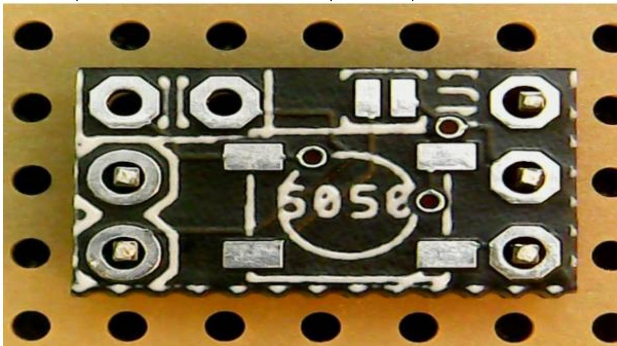
Im Anschluss wird die LED aufgelötet. Dies kann auch per Handlötzung erfolgen, wenn es noch nicht zu viel Kaffee zum Frühstück gab. Als erstes auf das Lötpad unten links etwas Lötzinn geben und kurz auskühlen lassen.
