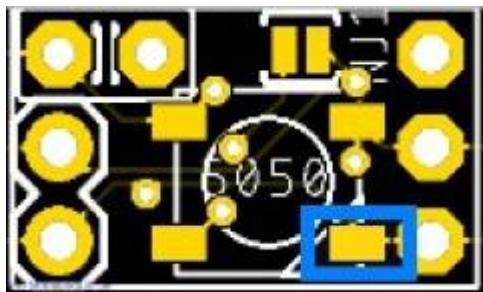
Nun mit einer breiten Pinzette die LED nehmen und grob ausrichten, dass die Markierung der LED zu dem Lötpad unten rechts ausgerichtet ist.
