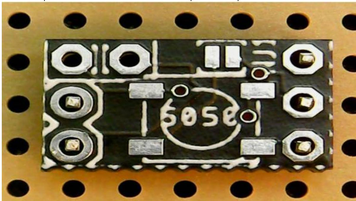
Im Anschluss wird die LED aufgelötet. Dies kann auch per Handlötzung erfolgen, wenn es noch nicht zu viel Kaffee zum Frühstück gab. Als erstes auf das Lötpad unten links etwas Lötzinn geben und kurz auskühlen lassen.
