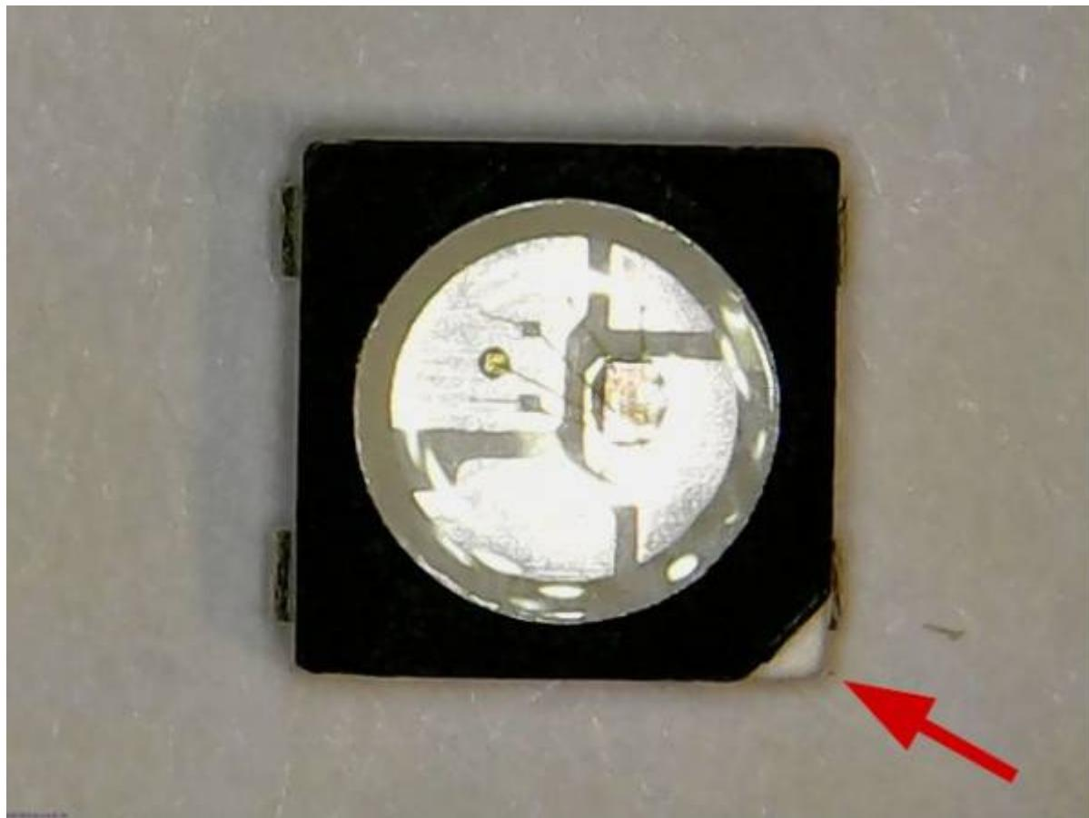
Das Lötzinn mit dem Lötkolben wieder schmelzen und die LED mit der Pinzette auf das Lötpad mit dem geschmolzenen Lötzinn legen und den Lötkolben entfernen. Nach ca. 5 Sekunden ist das Lötzinn wieder fest und man kann die LED loslassen.
