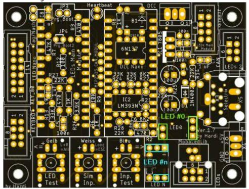
Als letztes Bauteil auf der Oberseite kommt der Anschluss für das SX-Signal. Je nachdem was man verwenden möchte, kommt entweder X3 (rot) oder X5 (violett) auf dei Platine.
