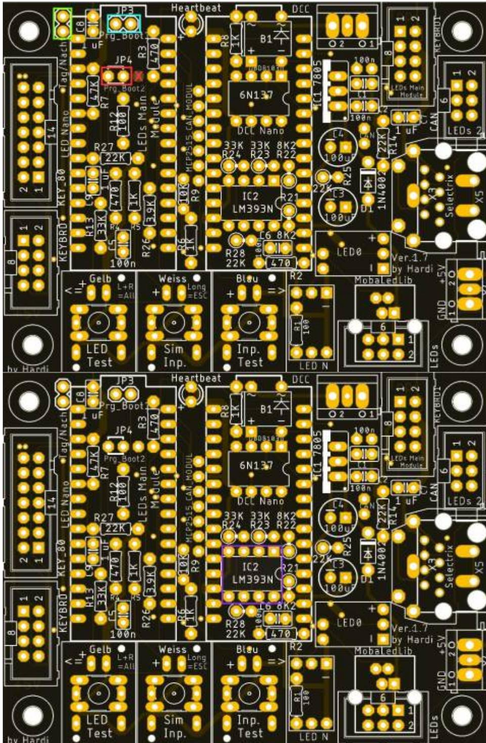
Die nächsten Bauteile sind die vier Buchsenleisten für die beiden Arduinos. Damit diese passen, müssen die Leisten, sollte man die aus dem Reichelt Warnkorb gekauft haben, auf 15 Pole gekürzt werden.
