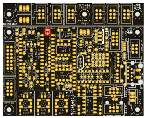
Als nächstes folgen die beiden Keramikkondensatoren C7 & C9 (je 1,0  $\mu$ F).
