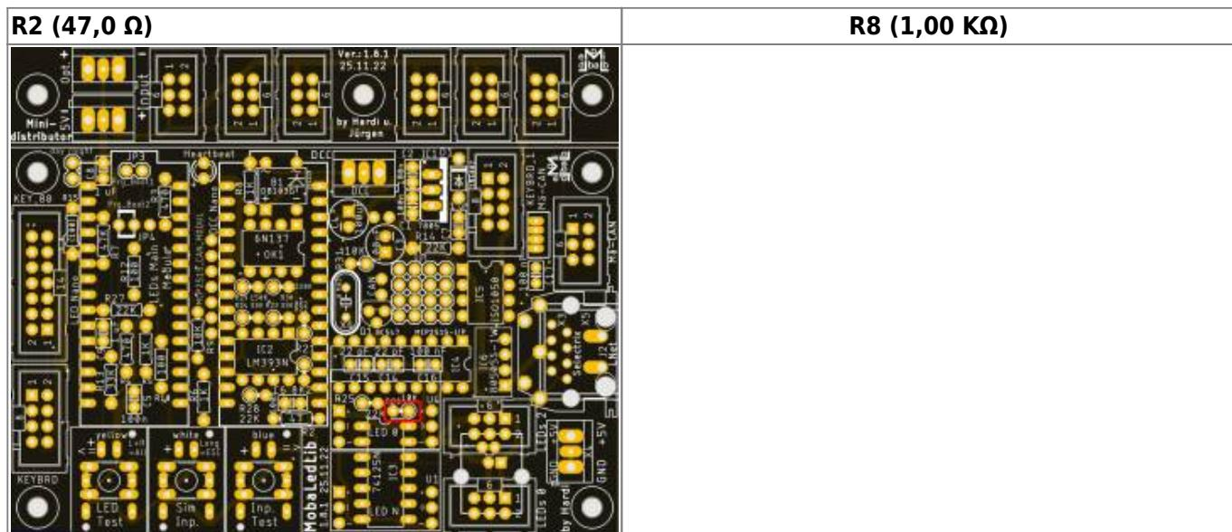
gefolgt von den Keramikkondensatoren C5 und C6 (je 100nF).
