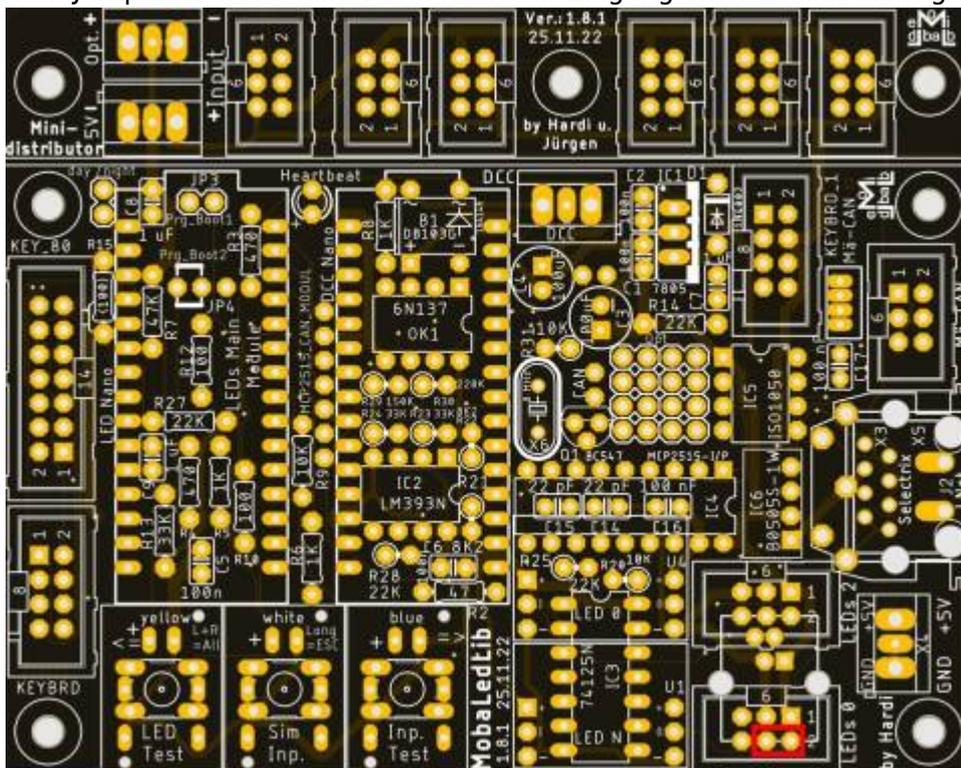
Sollte der Mini-Distributor von der Hauptplatine getrennt worden sein, bitte den Lötjumper „MINI\_VERT“ (grün) schließen. Der Lötjumper „J3“ verbindet den Pin1 und Pin6 der Wannenstecker. [rot]Nicht schließen, wenn mehr als 5V am opt Eingang oder am Pin6 anliegen.[/rot] [weitere Infos](#)
