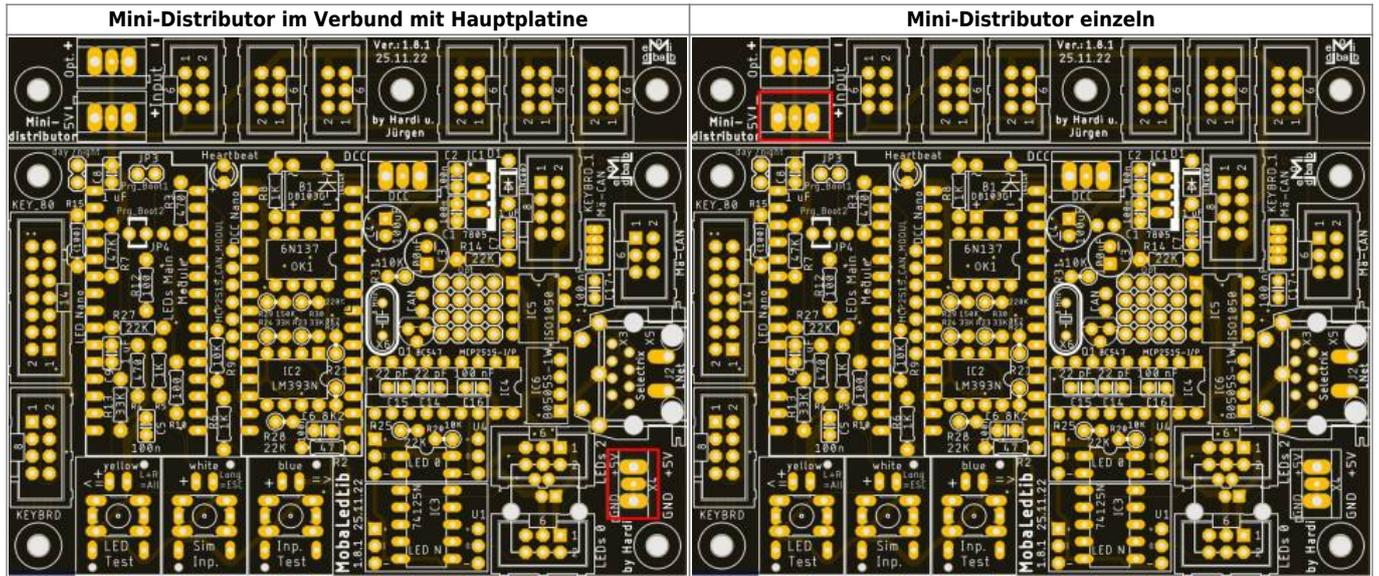
Wenn der Mini-Distributor noch an der Hauptplatine ist, bitte den Ausgang für den LED-Kanal #0 mit dem Jumper überbrücken. Dann kann der Eingang am Verteiler nicht genutzt werden.
