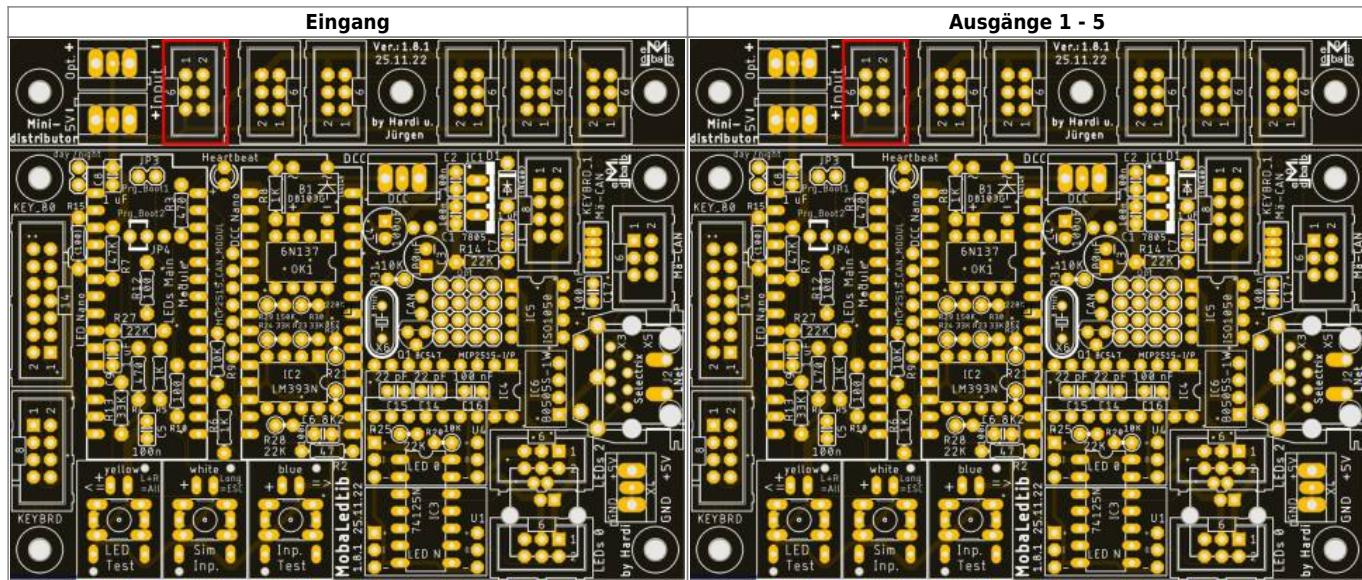
Danach werden die beiden Schraubklemmen eingelötet.
