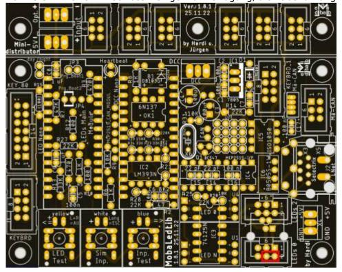
Sollte der Mini-Distributor von der Hauptplatine getrennt worden sein, bitte den Lötjumper "MINI\_VERT" (grün) schließen.
