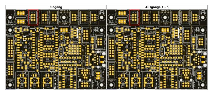
Danach werden die beiden Schraubklemmen eingelötet.
