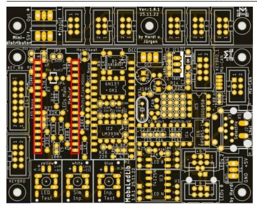
Nun folgt der Anschluss für das Signal vom CAN-Bus. Dazu kann etweder ein Wannenstecker oder ein JST-Stecker verwendet werden.
