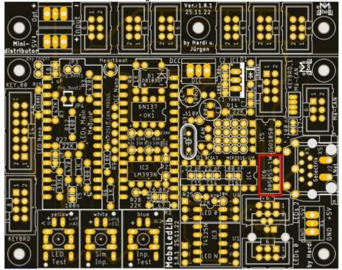
Die nächsten Bauteile sind die zwei Buchsenleisten für die LED-Arduino. Damit diese passen, müssen die Leisten, sollte man die aus dem Reichelt Warenkorb gekauft haben, auf 15 Pole gekürzt werden.
