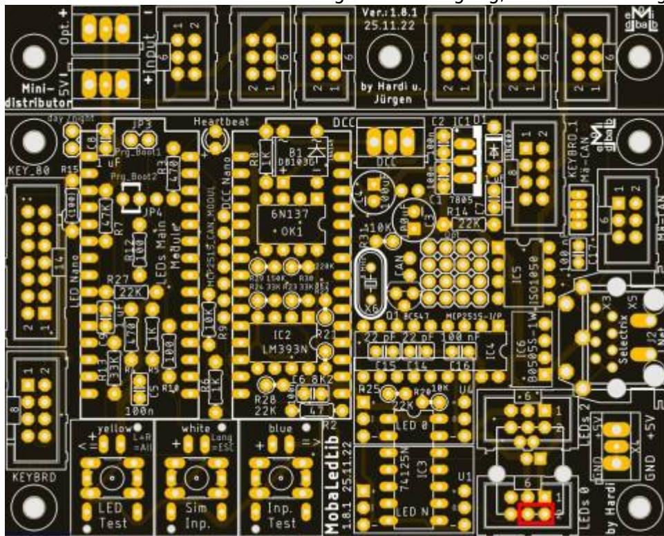
Sollte der Mini-Distributor von der Hauptplatine getrennt worden sein, bitte den Lötjumper „**MINI\_VERT**“ (grün) schließen. Der Lötjumper „J3“ verbindet den Pin1 und Pin6 der Wannenstecker. Nicht schließen, wenn mehr als 5V am opt. Eingang oder am Pin6 anliegen.[weitere Infos](#)
