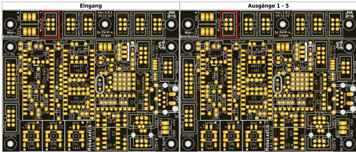
Danach werden die beiden Schraubklemmen eingelötet.
