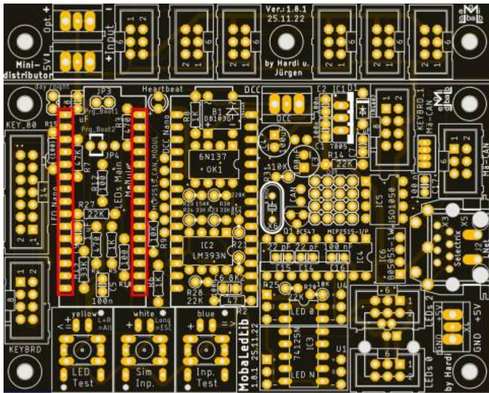
Nun folgt der Anschluss für das Signal vom CAN-Bus. Dazu kann entweder ein Wannenstecker oder ein JST-Stecker verwendet werden.
