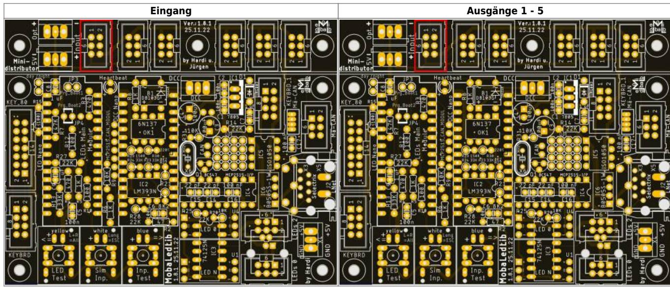
Danach werden die beiden Schraubklemmen eingelötet.
