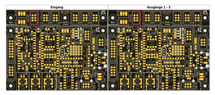
Danach werden die beiden Schraubklemmen eingelötet.
