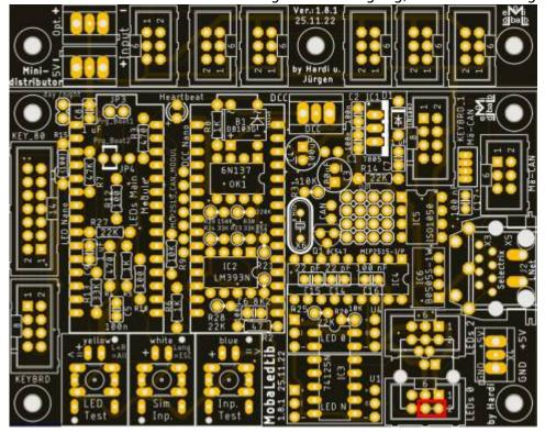
Sollte der Mini-Distributor von der Hauptplatine getrennt worden sein, bitte den Lötjumper "MINI\_VERT" (grün) schließen. Der Lötjumper "J3" verbindet den Pin1 und Pin6 der Wannenstecker. Nicht schließen, wenn mehr als 5V am opt. Eingang oder am Pin6 anliegen.weitere Infos
