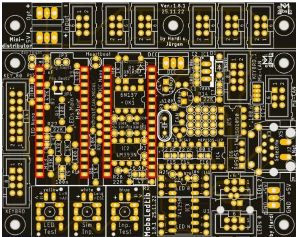
Nun folgt der Anschluss auf der Oberseite der Anschluss für das SX-Signal. Je nachdem was man verwenden möchte, kommt entweder X3 (links) oder X5 (rechts) auf die Platine.
