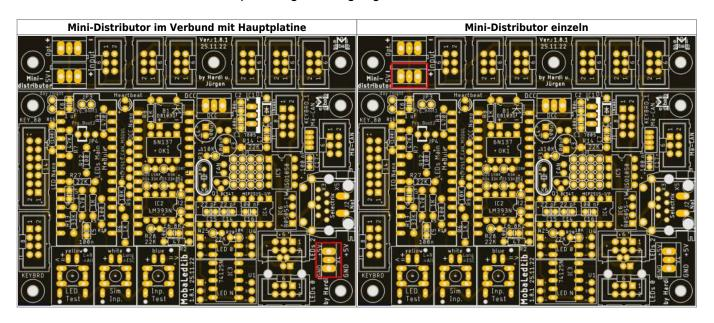
Wenn der Mini-Distributor noch an der Hauptplatine ist, kann der Ausgang für den LED-Kanal #0 mit dem Jumper überbrückt werden.
