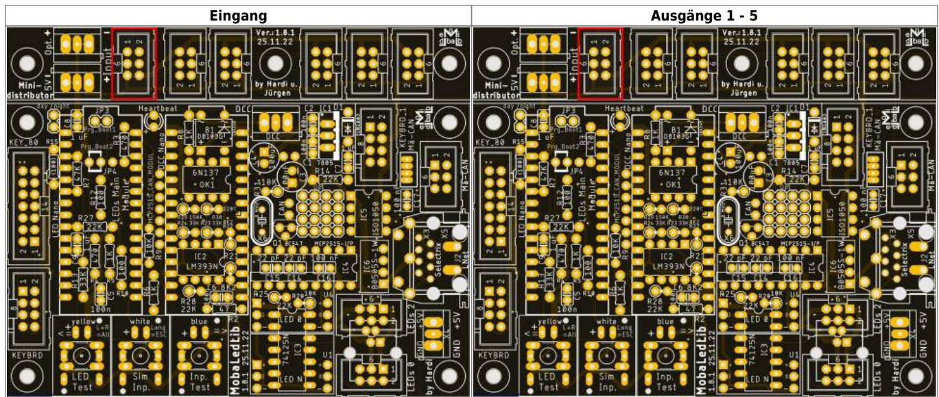
Danach werden die beiden Schraubklemmen eingelötet.
