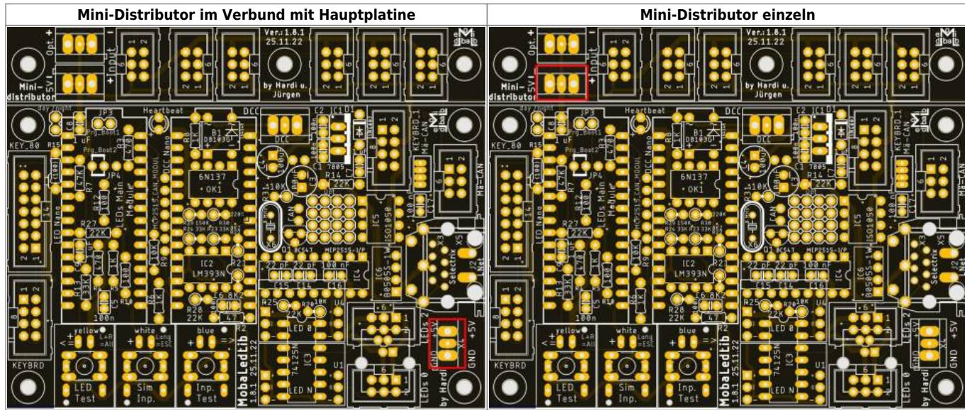
Wenn der Mini-Distributor noch an der Hauptplatine ist, kann der Ausgang für den LED-Kanal #0 mit dem Jumper überbrückt werden.
