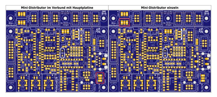
Sollte der Mini-Distributor von der Hauptplatine getrennt worden sein, bitte den Lötjumper "MINI\_VERT" (rosa) schließen. Der Lötjumper "J3" verbindet den Pin1 und Pin6 der Wannenstecker. Nicht schließen, wenn mehr als 5V am opt. Eingang oder am Pin6 anliegen.weitere Infos
