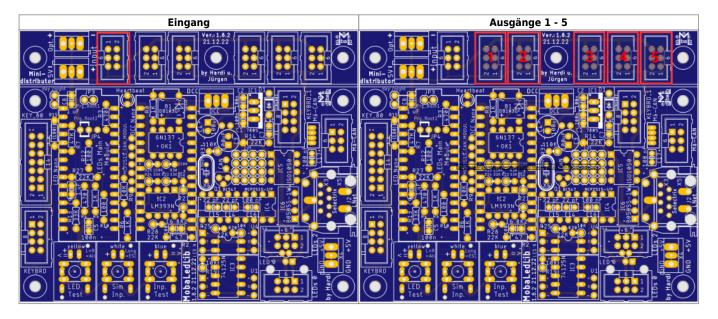
Danach werden die beiden Schraubklemmen eingelötet.
